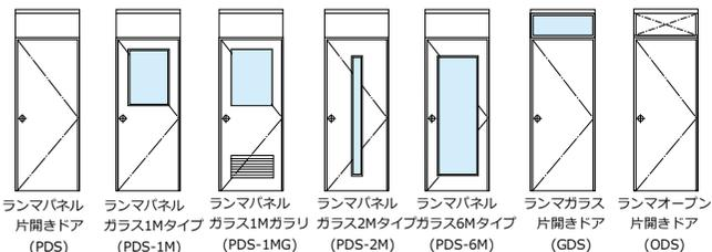
ランマパネル片開きドア (PDS) ランマパネルガラス1Mタイプ (PDS-1M) ランマパネルガラス1Mガラリ (PDS-1MG) ランマパネルガラス2Mタイプ (PDS-2M) ランマパネルガラス6Mタイプ (PDS-6M) ランマガラス片開きドア (GDS) ランマオープン片開きドア (ODS)
