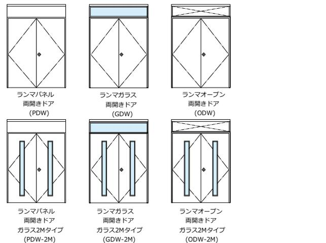
ランマパネル両開きドア (PDW) ランマガラス両開きドア (GDW) ランマオープン両開きドア (ODW) ランマパネル両開きドアガラス2Mタイプ (PDW-2M) ランマガラス両開きドアガラス2Mタイプ (GDW-2M) ランマオープン両開きドアガラス2Mタイプ (ODW-2M)
