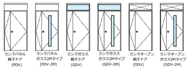
ランマパネル親子ドア (PDV) ランマパネルガラス2Mタイプ (PDV-2M) ランマガラス親子ドア (GDV) ランマガラスガラス2Mタイプ (GDV-2M) ランマオープン親子ドア (ODV) ランマオープンガラス2Mタイプ (ODV-2M)
